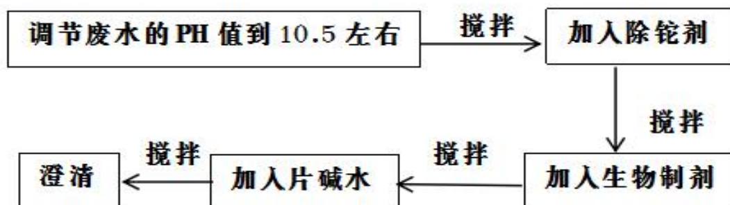
图 1 含铊废水处理工艺
